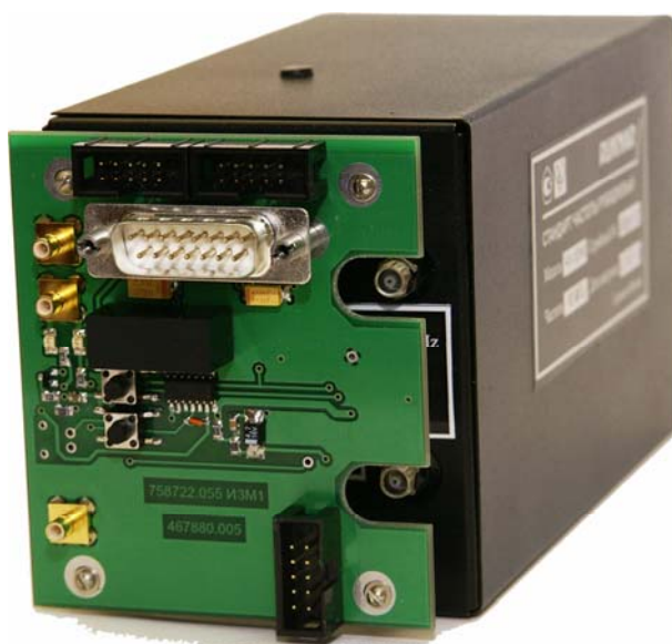
Рис.1 Внешний вид РСЧ Ч1-1014 с установленной платой приёмника РУГА.467880.005.
