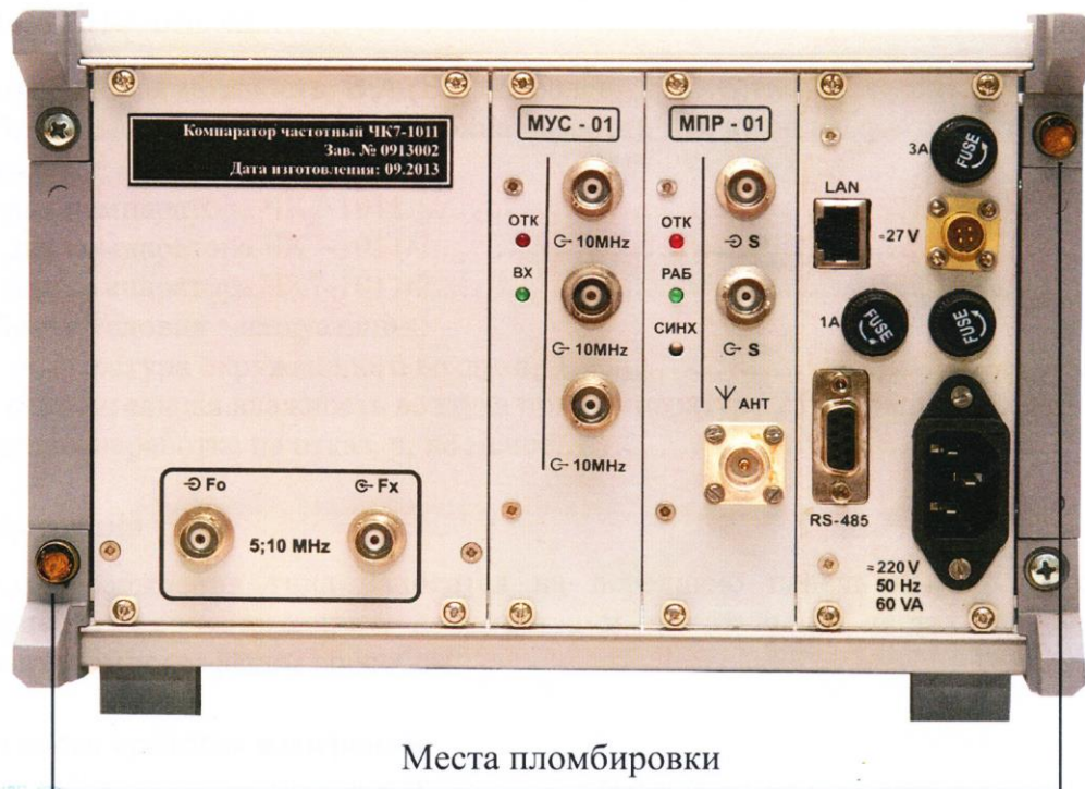
Рисунок 2 – Схема пломбировки от несанкционированного доступа.
