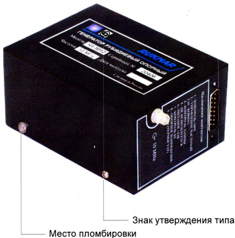
Рисунок 1 – Схема нанесения знака утверждения типа и места пломбировки от несанкционированного доступа.
