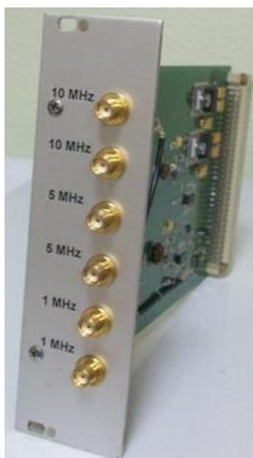
Предназначен для применения в стандартах частоты и времени Ч1-1011 и компараторах частотных ЧК7-1011. Обеспечивает на шести выходах синусоидальный сигнал с частотой 1 МГц (два выхода), 5 МГц (два выхода), 10 МГц (два выхода). Тип соединителя SMA. По требованию заказчика возможна любая комбинация выходных сигналов и типа соединителя. При установке в выше указанные приборы двух модулей усилителя общее количество выходных сигналов увеличивается до двенадцати.
